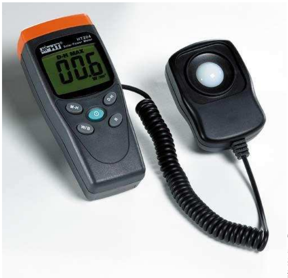
HT204 Solar Power Meter: solide und günstig, aber mit eingeschränkter Genauigkeit
